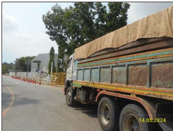
รูปที่ 2-4 รถบรรทุกขนส่งวัสดุก่อสร้างมีผ้าใบปิดคลุมอย่างมิดชิด
